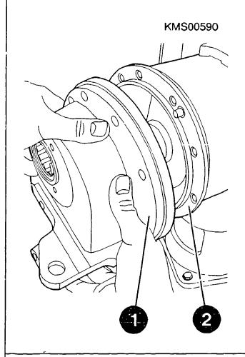
DISASSEMBLING REDUCTION GEAR (TYPE TF 0 001 613 ...)
